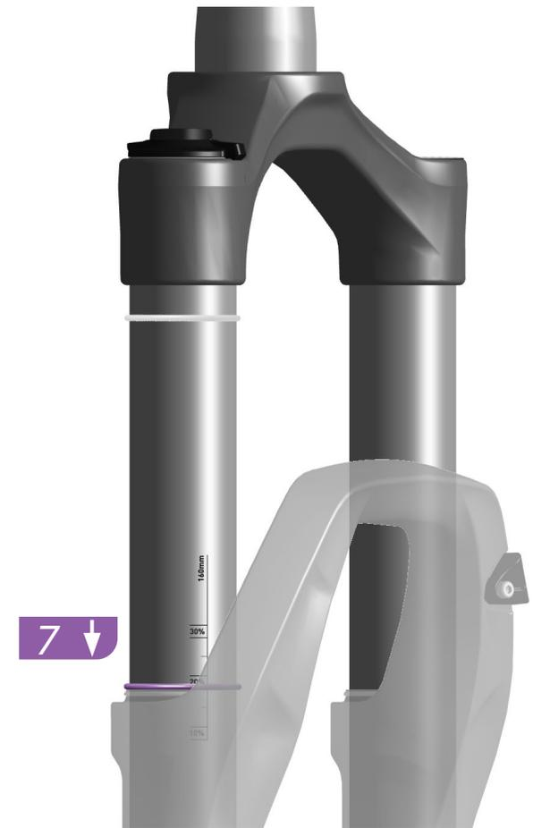
7. Bitten Sie Ihren Helfer, den Nachgiebigkeits-O-Ring nach unten bis zur Oberseite der Staubabstreiferdichtung zu schieben.
