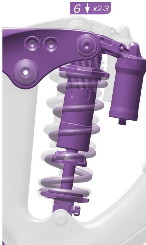
6. Bitten Sie einen Helfer, das Fahrrad zu halten, steigen Sie mit Fahrradbekleidung auf das Fahrrad und lassen Sie den Dämpfer zwei bis drei Mal leicht durchfedern, während Sie auf den Pedalen stehen.
