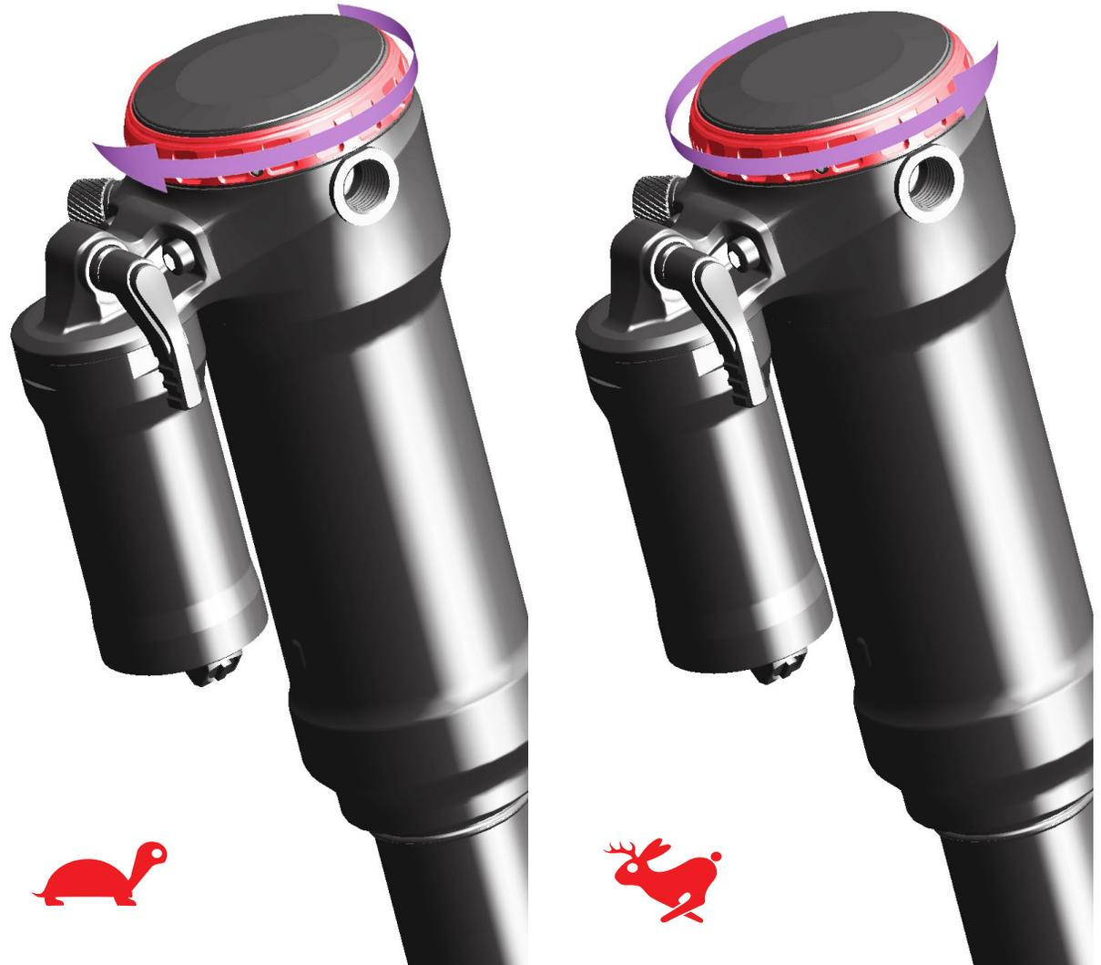
Um die Ausfedergeschwindigkeit zu **verringern** (langsamere Rückkehr), drehen Sie den Zugstufeneinsteller **im Uhrzeigersinn**.
