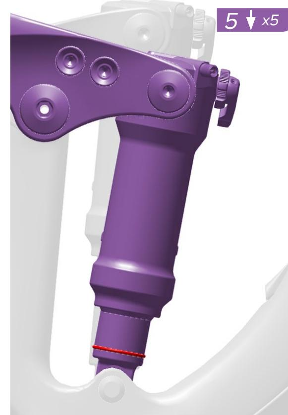
5. Lassen Sie den Dämpfer fünfmal vollständig einfedern, um die positiven und negativen Luftfedern auszugleichen.
