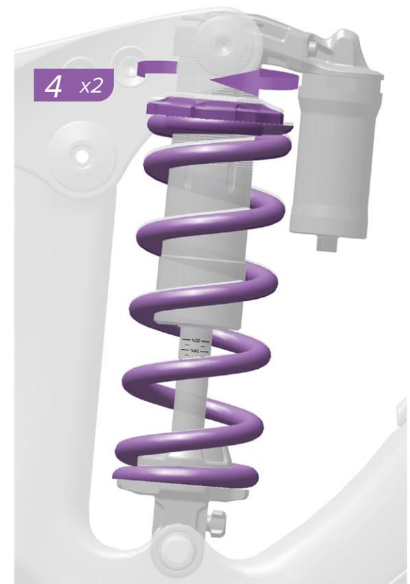
4. Drehen Sie den Vorspannungseinsteller der Feder um zwei volle Umdrehungen im Uhrzeigersinn.
