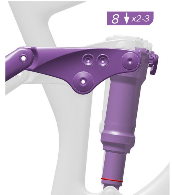
8. Bitten Sie einen Helfer, das Fahrrad zu halten, steigen Sie mit Fahrradbekleidung auf das Fahrrad und lassen Sie den Dämpfer zwei bis drei Mal leicht durchfedern, während Sie auf den Pedalen stehen.
