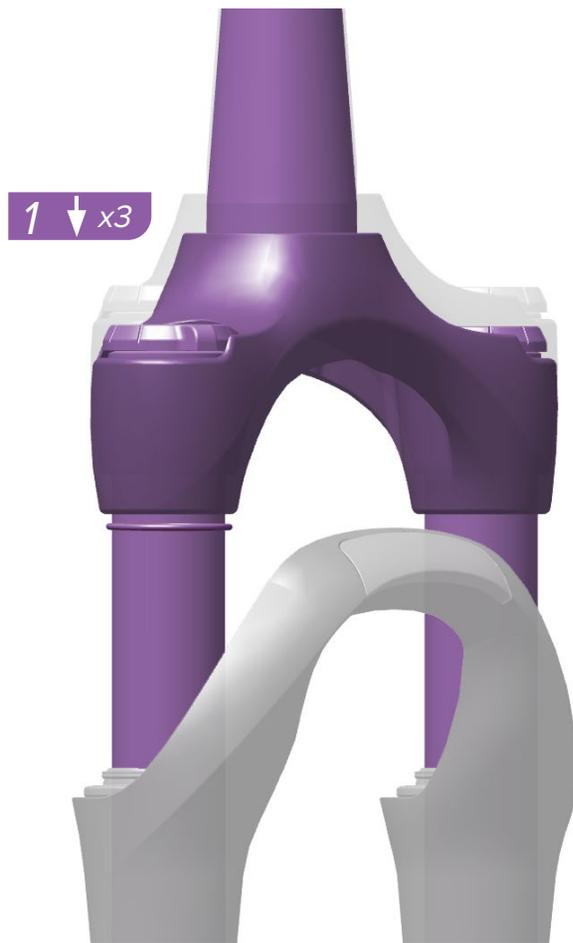
1. Bitten Sie einen Helfer, das Fahrrad zu halten, stellen Sie sich mit Fahrradbekleidung auf die Pedale und lassen Sie den Dämpfer drei Mal einfedern. Setzen oder stellen Sie sich dann in Ihrer normalen Fahrposition auf das Fahrrad.
