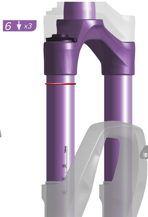
6. Bitten Sie einen Helfer, das Fahrrad zu halten, stellen Sie sich mit Fahrradbekleidung auf die Pedale und lassen Sie den Dämpfer drei Mal einfedern. Setzen oder stellen Sie sich dann in Ihrer normalen Fahrposition auf das Fahrrad.
