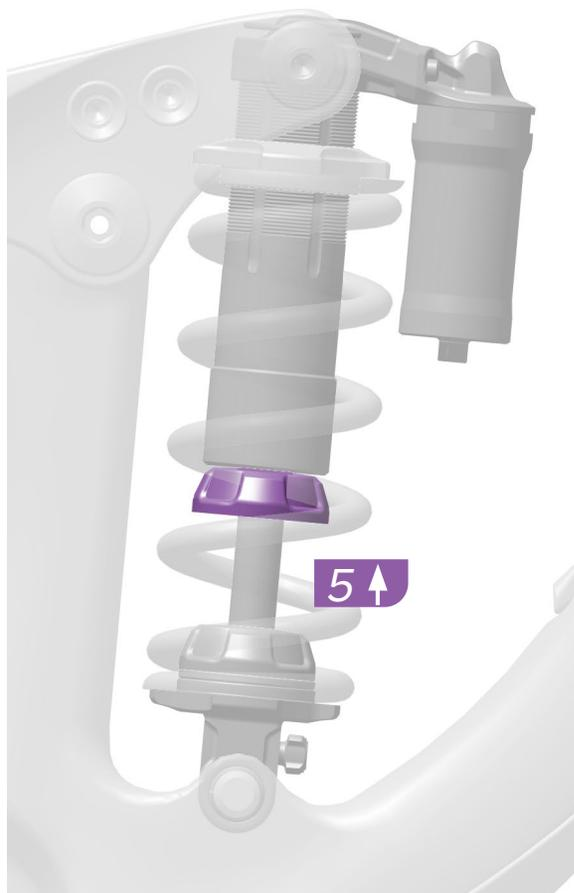
5. Schieben Sie den Anschlagpuffer zum Dämpferkörper.
