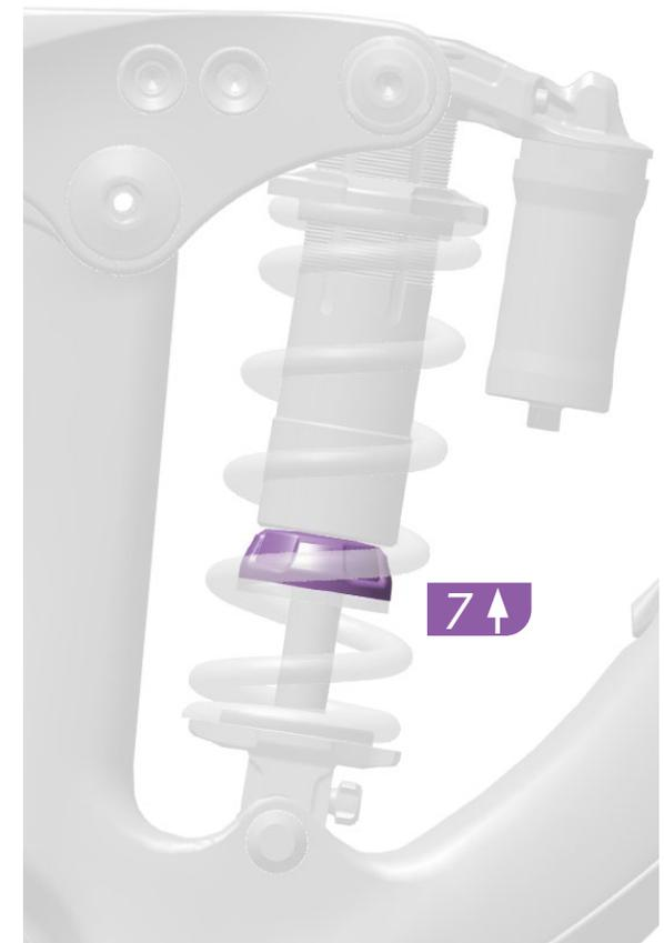
7. Während Sie auf dem Fahrrad sitzen, bitten Sie einen Helfer, den unteren Anschlagpuffer gegen die Abstreiferdichtung zu schieben.
