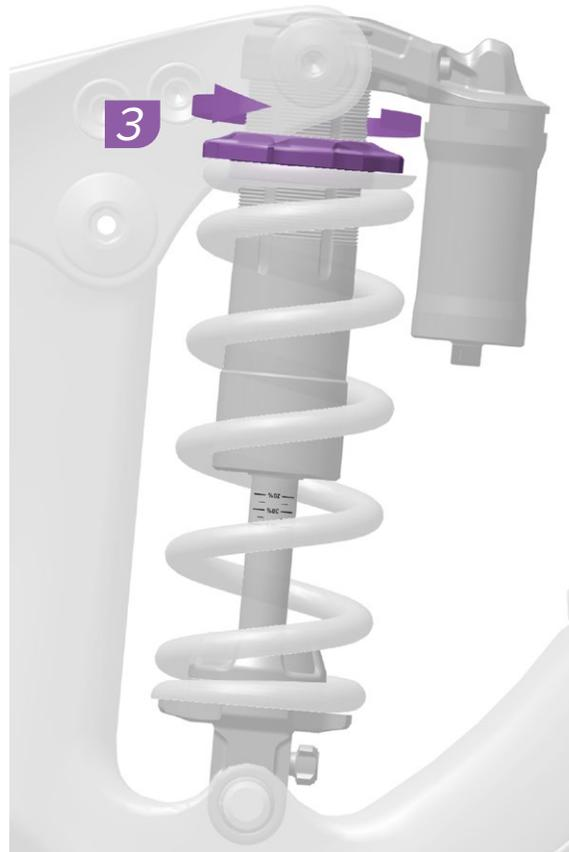
3. Drehen Sie den Vorspannungseinsteller gegen den Uhrzeigersinn, bis Sie keinen Widerstand mehr spüren.
