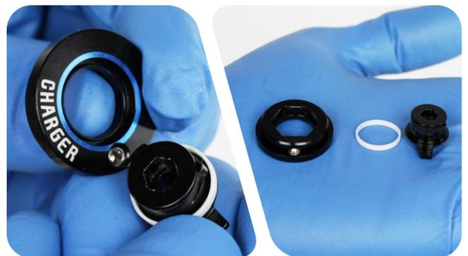
Montieren Sie den Fernbedienungsring auf dem Sechskanteinsteller, und richten Sie die Zugschraube des Fernbedienungsrings auf 87 Grad aus.
