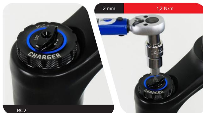
**RC:** Montieren Sie den Druckstufeneinstellring mit der Nase nach vorn in der entsperrten Position auf der Abdeckkappe.
