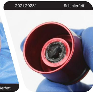
**5** Montieren Sie die neue Dichtkopf-Baugruppe auf der Luftführungsstange.
