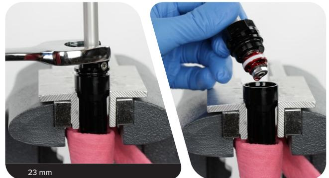
**8** Entfernen Sie den Dichtkopf von der Zugstufendämpfer-Führungsstange und entsorgen Sie ihn.
