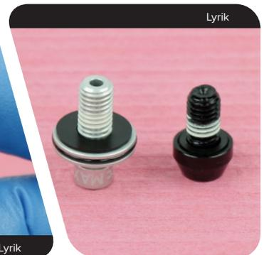
**7** Setzen Sie die schwarze untere Schraube in die Führungsstange auf der Federseite ein.
