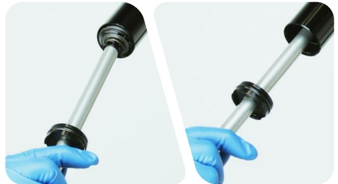
Schieben Sie den Dichtkopf in das Standrohr, bis die Sicherungsring-Nut zu sehen ist.
