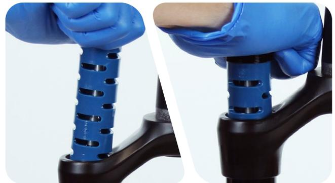
Schrauben Sie die Abdeckkappe in das Standrohr.
