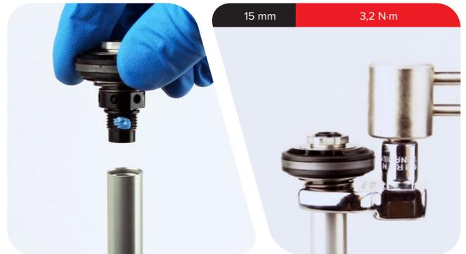
**2** Führen Sie den Zugstufendämpfer und den Dichtkopf in das Standrohr ein.
