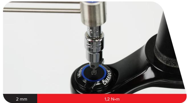
**3b RCT R:** Bringen Sie den Zuganschlagring mit der Zugführung in der 6-Uhr-Position in einem Winkel von ca. 20 Grad zum Mittelpunkt an.
