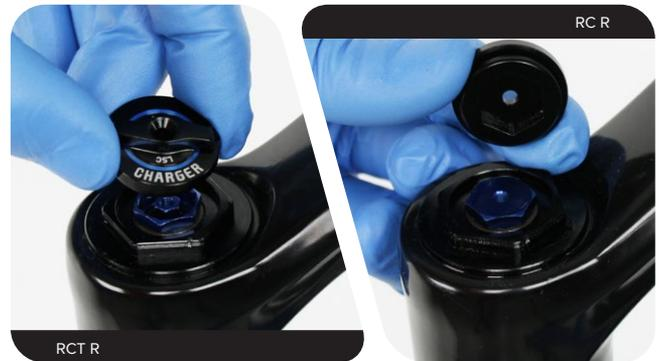
**6** Lösen Sie die Dämpfer-Abdeckkappe und entfernen Sie die Charger 2 Damper/Charger 2.1 Damper-Dämpfer-Baugruppe.
