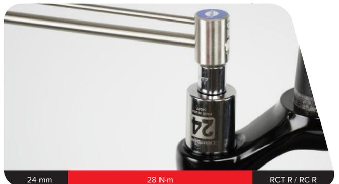
**3a RCT3:** Montieren Sie den Druckstufenmodus-Einstellung mit der Nase nach vorn in der entsperrten Position auf der Abdeckkappe.
