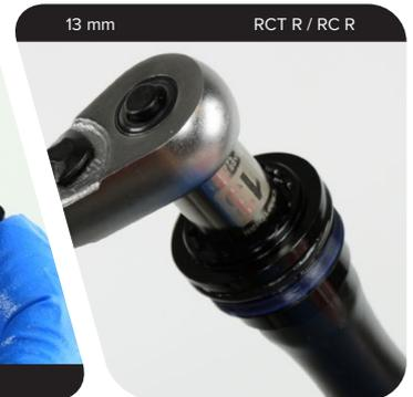
Schieben Sie die Dämpfer-Baugruppe nach unten, um die Entlüftung zu überprüfen.
