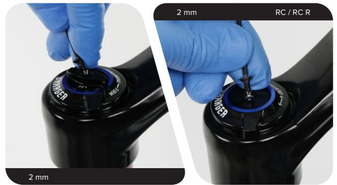
**3** **RC2 / RCT3 / RC:** Entfernen Sie den Lowspeed-Druckstufeneinstellung.
