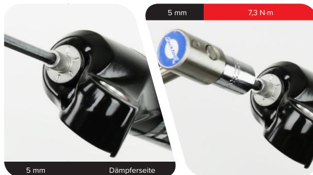
**8** **Lyrik:** Bauen Sie den Zugstufendämpfer-Einstellung ein und ziehen Sie die Feststellschraube fest.
