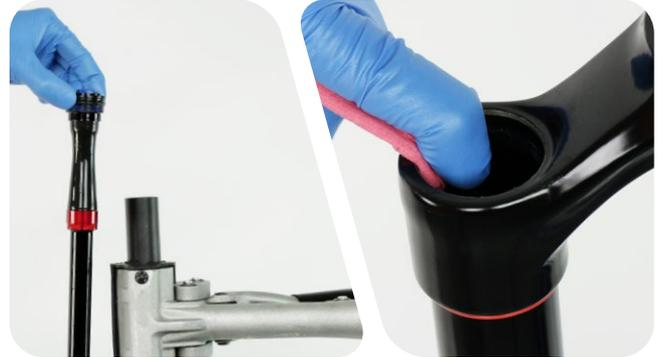
**7** Lösen und entfernen Sie die Zugstufendämpfer-Dichtkopf-Baugruppe langsam vom Patronenrohr.
