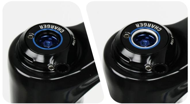
Setzen Sie den Low-speed-Einstellung auf den Sechskanteinsteller auf. Bringen Sie die Befestigungsschraube des Einstellrings an und ziehen Sie sie fest.
