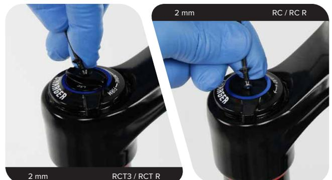
**3 RCT R / RC R:** Lösen Sie die Feststellschraube des Fernbedienungszug-Anschlagrings und entfernen Sie den Ring.
