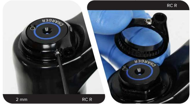
**4 RCT R:** Entfernen Sie den Lowspeed-Einstellring/die Fernbedienungsring-Baugruppe.
