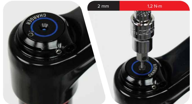
**4 RCT R / RC R:** Ziehen Sie die Feststellschraube des Zuganschlagrings fest.
