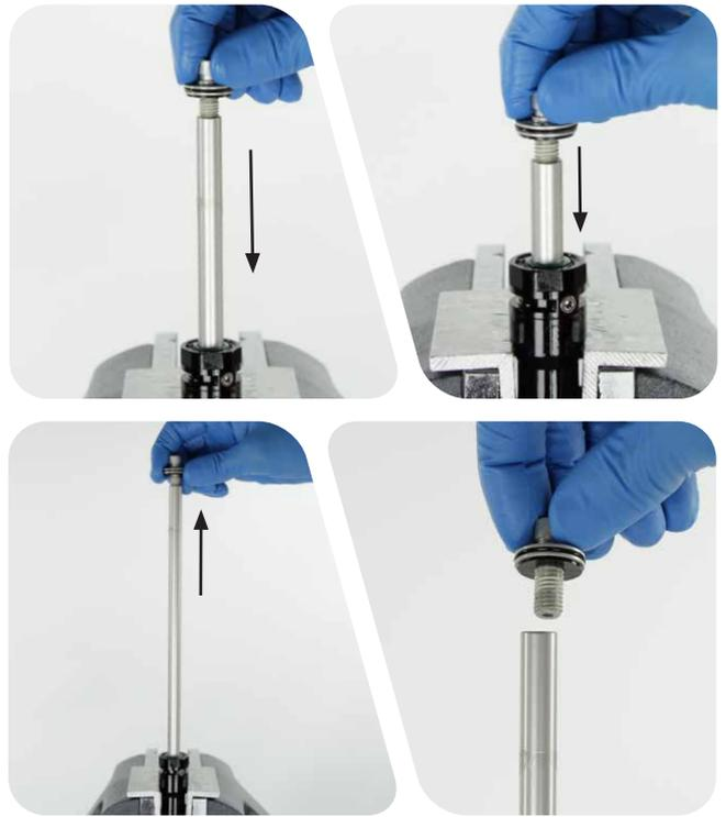
**1 RCT3 / RCT R:** Drehen Sie die Druckstufennocke bis zum Anschlag im Uhrzeigersinn in die gesperrte Position.
