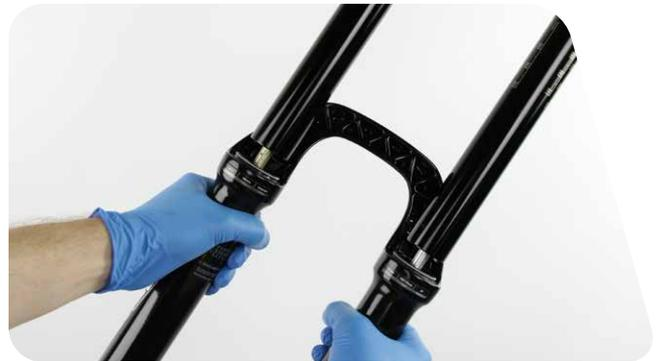
Das innere untere Ende des unteren Gabelbeins sollte die Feder oder Dämpferführungsstangen nicht berühren. Zwischen den Führungsstangenenden und den Schraubenbohrungen in den unteren Gabelbeinen sollte eine Lücke zu sehen sein.
