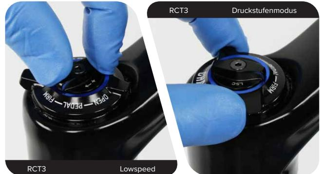
**RCT R:** Drehen Sie den Lowspeed-Druckstufeneinstellring bis zum Anschlag gegen den Uhrzeigersinn in die vollständig offene Position.
