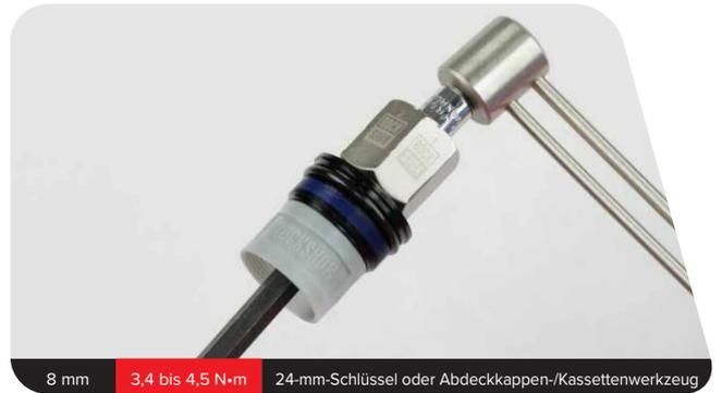
**Dual Position Air:** Montieren Sie Bottomless Tokens nach Bedarf auf der DPA-Luftfeder-Führungsstange.
