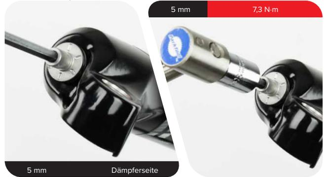
**8** **Lyrik:** Bauen Sie den Zugstufendämpfer-Einstellring ein und ziehen Sie die Feststellschraube fest.
