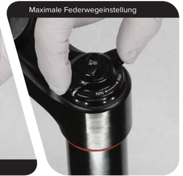
Stellen Sie die Gabel senkrecht auf dem Boden und platzieren Sie unter jedem Ende der Tauchrohren eine dünne Gummimatte. Drücken Sie die Gabel auf mindestens 50 % des gesamten Federwegs zusammen, und lassen Sie die Gabel dann wieder vollständig ausfedern. Vergewissern Sie sich, dass die Gabel auf den maximalen Federweg eingestellt ist (180 mm, 170 mm oder 160 mm), bevor Sie fortfahren.
