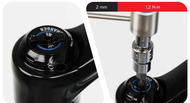
**RC R:** Bringen Sie den Zuganschlagring mit der Zugführung nach vorne in der 6-Uhr-Position bzw. in einem Winkel von ca. 20 Grad zum Mittelpunkt an.
