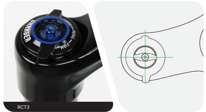
Montieren Sie den Lowspeed-Druckstufeneinstellung auf der Sechskantstange des Einstellers.
