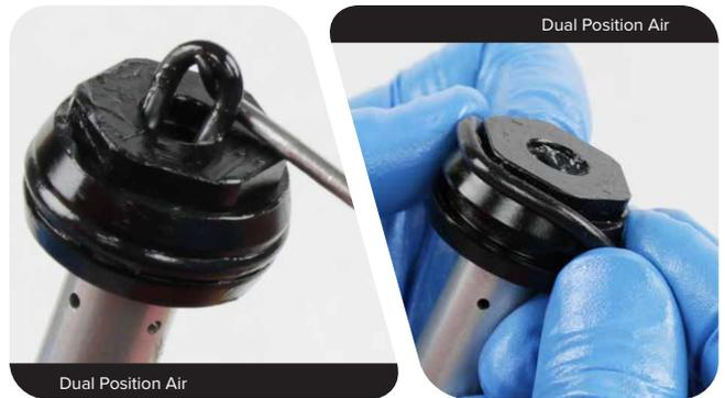
**DebonAir:** Entfernen Sie die Vierkant-Ringdichtung vom Luftkolben und entsorgen Sie sie.
