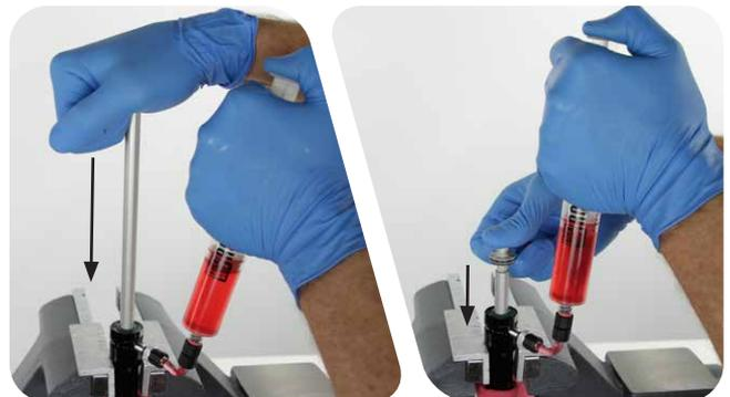
Ziehen Sie die Zugstufendämpfer-Führungsstange langsam aus dem Patronenrohr heraus und üben Sie leichten Gegendruck auf den Spritzenkolben aus, während das Öl den Dämpfer füllt.
