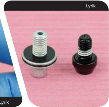
**7** Setzen Sie die schwarze untere Schraube in die Führungsstange auf der Federseite ein.
