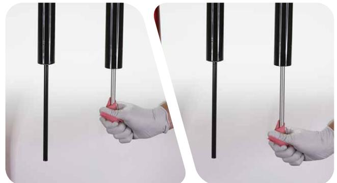
**4 Dual Position Air:** Entfernen Sie die Sicherungsmutter des Federweg-einstellrings.
