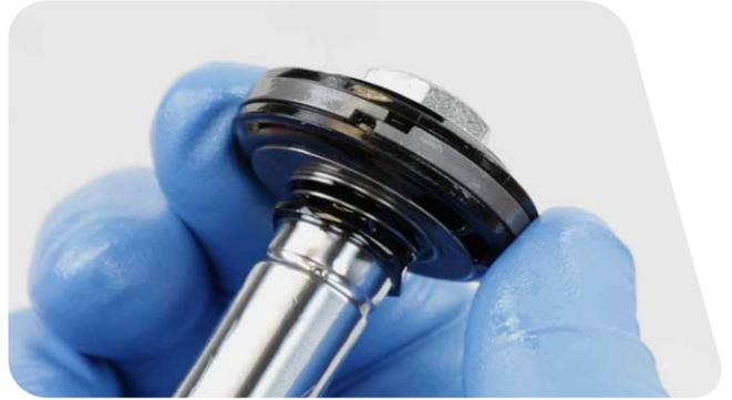
**1** Schieben Sie den Dichtkopf auf die Zugstufendämpfer-Führungsstange. Dabei muss das flache Ende zum Zugstufendämpferkolben weisen.
