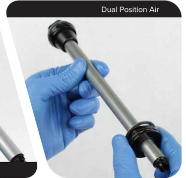
**5** Tragen Sie Schmierfett auf den Luftkolben sowie die äußeren O-Ringe/ Dichtungen des Dichtkopfs auf.
