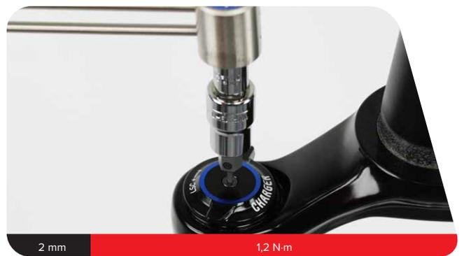
**3b RCT R:** Bringen Sie den Zuganschlagring mit der Zugführung nach vorne in der 6-Uhr-Position bzw. in einem Winkel von ca. 20 Grad zum Mittelpunkt an.
